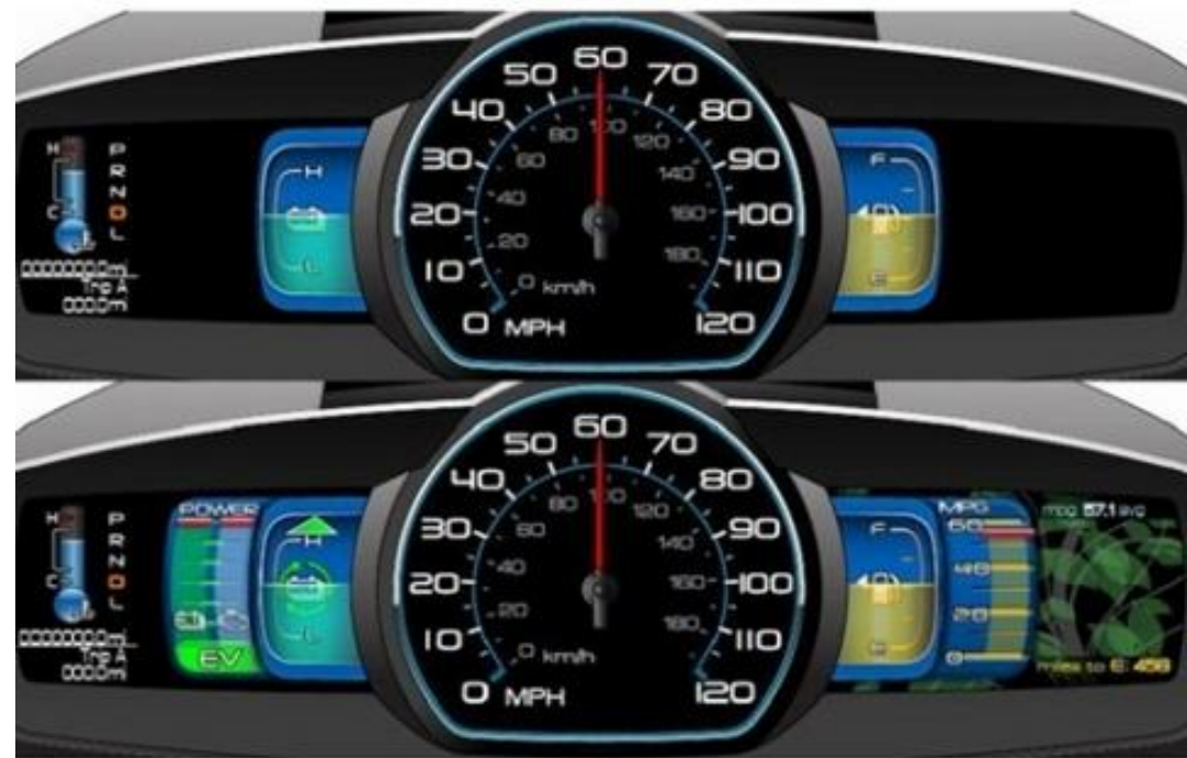
포드의 하이브리드 자동차 퓨전의 계기판 상 시동 전 계기판. 下 경제속도로 운전할 경우 녹색 앞사귀가 자 라고 급가속시 녹색의 앞이 갈색으로 변하고 떨어짐. 운전습관을 변화시켜서 연비를 절감시키기 위한 디자인적인 혁신
